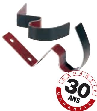
Pour la fixation des faîtières et des arêtiers, on utilise un crochet pour faîtière en aluminium, une vis en inox avec rondelle et anneau en néoprène (4,5 x 80 mm) ou en cas de bâtiments fort exposés, une combinaison.
