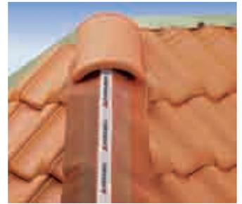
Les arêtiers ou faîtières sont posés au-dessus de la sous-faîtière en plomb et sont fixés au moyen de vis en inox avec rondelle et bague d'étanchéité en néoprène (4,5 x 80 mm) et/ou d'un crochet pour faîtière spécial en aluminium.
