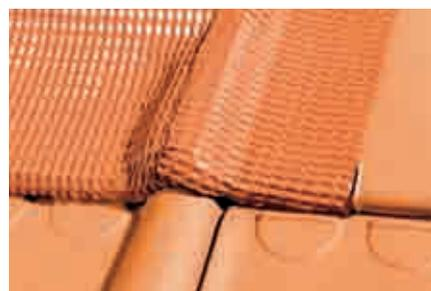
Commencez toujours par appuyer Koraflex à partir du haut de l'onde vers le milieu de la tuile. La pression s'effectue de préférence à la main. Si les bandes ne sont pas fixées immédiatement, les morceaux libres doivent être protégés contre le vent, par exemple en les fixant dans les joints avec des crochets ou sur les lattes à l'aide de clous en cuivre tous les 50 cm.
